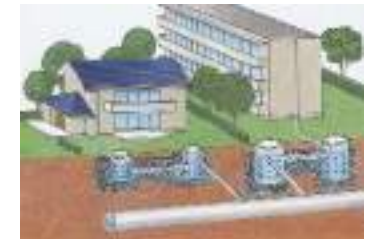
▲雨水浸透施設設置例
